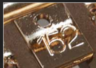
Numerazione con punzone sulla montatura con riferimento ai vetri codificati. Frame with punched-in numbering referring to the glass-parts produced and separately encoded.
