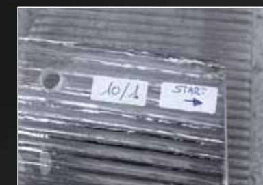
Pannello numero 1: sequenza e partenza per il corretto montaggio (senso antiorario). Panel number 1: sequence and starting point for a correct assembly (counterclockwise).
