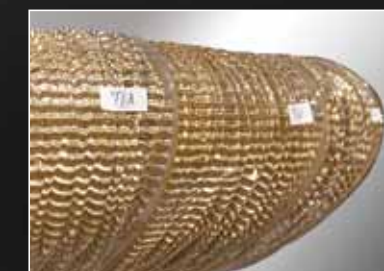
Etichettatura ed incisione con numerazione completa per tutti i pannelli di vetro. Complete numbering of all glass panels by labelling and engraving.
