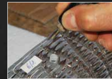
Etichettatura e incisione su vetro della numerazione progressiva. Labelling and engraving on the glass of the progressive numbering.
